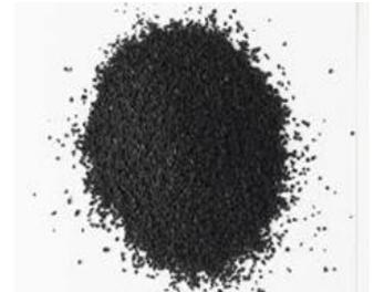
2. **SBR encapsulada ou pintada:** É a mesma borracha SBR Preta com uma cobertura em tinta de poliuretano na cor desejada, melhorando o aspecto visual e diminuindo a absorção de calor.
